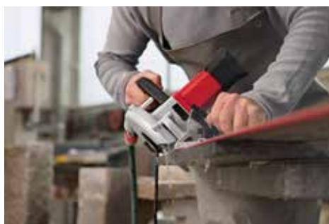
Plynulé nastavení úhlu pro pokosové řezy v rozsahu 0 až 45°
